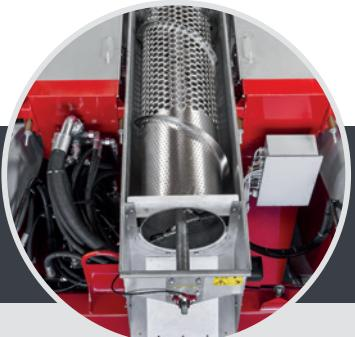
El aspirador central retira las hojas antes de que entren los racimos en el desgranador. Es elevable hidráulicamente para un acceso simple, para realizar el mantenimiento y la limpieza.
