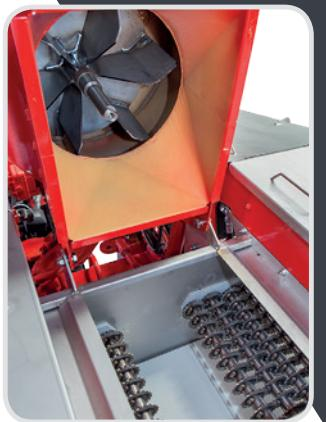
El aspirador central es elevable hidráulicamente, para un mantenimiento simplificado.
