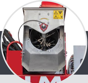
Salida trasera de los residuos clasificados por el desgranador. Simple y directa, permite controlar rápidamente el reglaje del desgranador.
