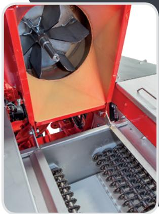
L'aspiratore centrale è sollevabile idraulicamente per una manutenzione semplificata.
