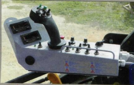
**LE BOÎTIER DE COMMANDE**, en cabine, est basique mais fonctionnel. La poignée offre les fonctions de marche/arrêt des secoueurs, de guidage, de correction de dévers et d'assiette. Les deux petits écrans affichent la fréquence de secouage ainsi que la vitesse de l'égreneur et des convoyeurs (en option).
