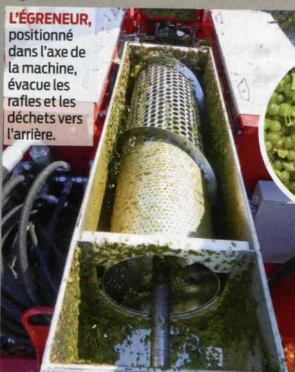
**L'ÉGRENEUR**, positionné dans l'axe de la machine, évacue les rafles et les déchets vers l'arrière.
