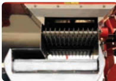
La Table-Séparateur à vitesse variable, simple et résistante, comprend 18 rouleaux à disques crantés.
