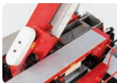
L'Aspirateur central également à vitesse variable, est relevable hydrauliquement.
